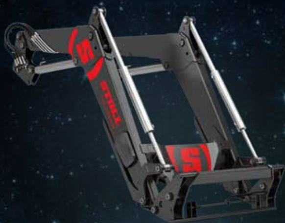
Výkyvné rameno FZ s mechanickým paralelním vedením (paralelogram): silná řešení pro profesionály od profesionálů.
