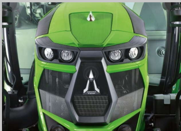
Úzká geometrie kapoty umožňuje ten nejlepší výhled na každé nářadí. Přední pracovní halogenová světla jsou dodávána ve standardní výbavě.
