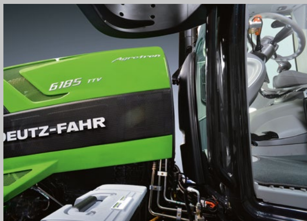
Kabina a motor jsou nově zcela odděleny. Díky snížení hluku a vibrací je tak zajištěn maximální komfort
