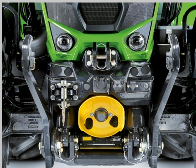
Nový přední tříbodový závěs s polohovou regulací (pouze u modelů TTV) a kapacitou zdvihu až 5.480 kg.
