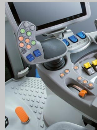
RCshift – nová, plně automatická převodovka s částečným řazením pod zátěží a nejlepší efektivitou přenosu síly – ve dvou variantách s mechanickými nebo elektrohydraulickými přídatnými okruhy.
